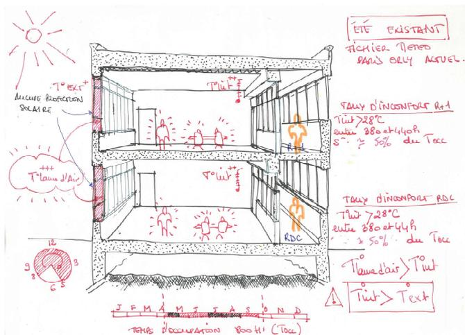
Coupe – fonctionnement bioclimatique avant travaux
