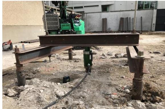
Dans notre cas, les essais en compression ont été excellents mais les essais en cisaillement ont donné des valeurs conformes mais un peu limite et il a été décidé de recourir à un diamètre un peu plus grand pour les pieux isolés ; les nouveaux essais avec un pieu de diamètre à peine supérieur, ont permis de réduire le risque de déplacement sous charge horizontale ( vent) de moitié, soit 3mm.
